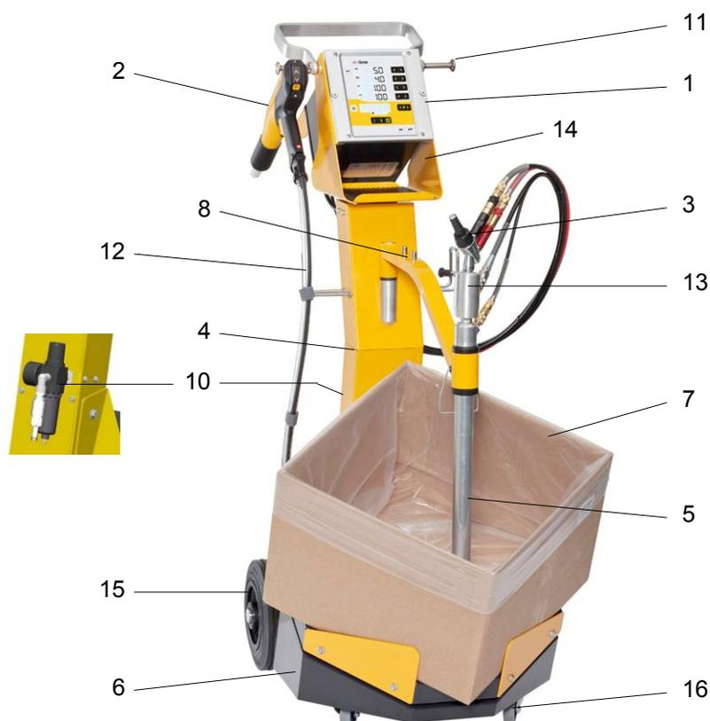
*Ручная установка напыления OptiFlex 2 B - Конструкция*
