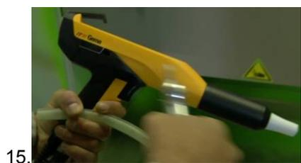
16. Снять распылитель, прочистить и продуть пистолет
